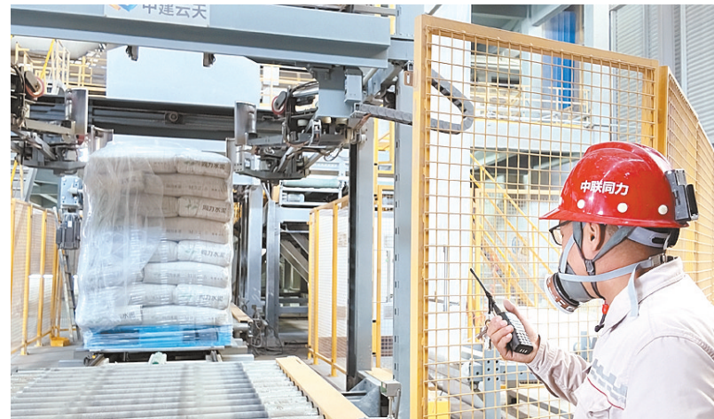
包装车间内，自动化设备有序运转，完成水泥产品自动包装。⑥5
