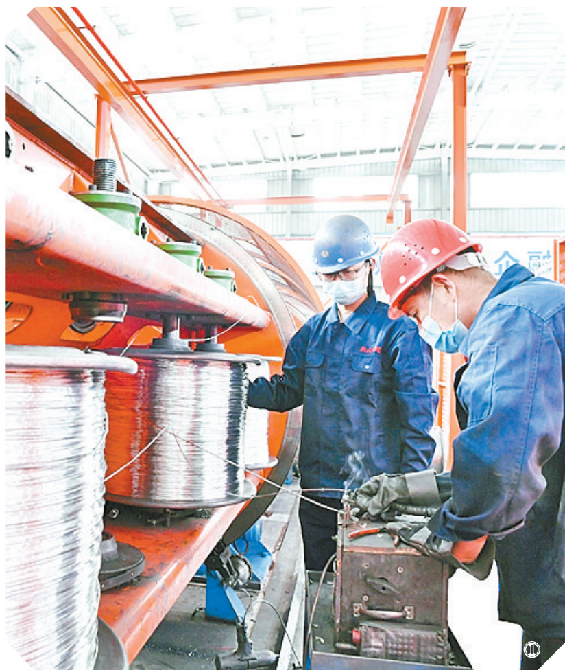
图① 工人正在进行铝单丝焊接。图② 架空导线绞制生产车间一角。图③ 工人正在检验即将出厂的产品。⑥5 本报记者 弓华静 摄
