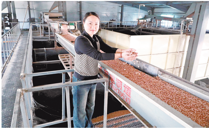
日前，在正阳县傅寨乡熊楼村小张庄黄斌花生米精选厂精选车间看到，花生米沿着传送带输送到筛选机，经过筛选、分级、包装、装车后销往全国各地。⑥5 本报记者 李玉荣 本报见习记者 余川 摄影报道
